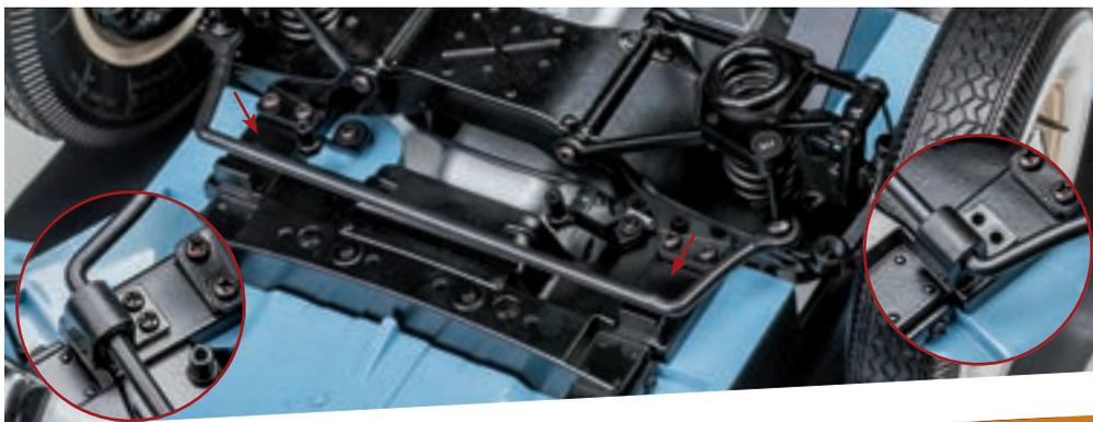
Поочередно слева и справа закрепите штангу стабилизатора поперечной устойчивости на передних лонжеронах при помощи двух кронштейнов штанги стабилизатора. Для фиксации используйте по два винта 1,7×4 (AM) на каждый кронштейн. При этом сама штанга в месте крепления должна располагаться на специальном упоре (прямоугольный выступ на лонжероне).
