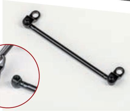
Соедините тягу сошки рулевого управления с двумя наконечниками. Обратите внимание: в одном из двух отверстий наконечников и на крепежной оси тяги имеются центровочные метки. Соедините детали таким образом, чтобы наконечники уходили от тяги назад и вниз. Закрепите детали при помощи двух винтов 1,7×3 с пресс-шайбой (НМ).
