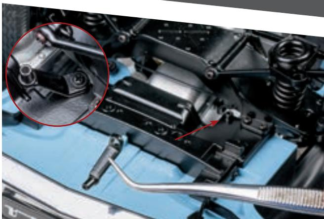
Установите маятниковый рычаг рулевой трапеции на оси, расположенной перед моторной балкой правее картера двигателя. Закрепите деталь на шасси при помощи винта 1,7×3 с пресс-шайбой (НМ). По окончании фиксации деталь должна оставаться подвижной.
