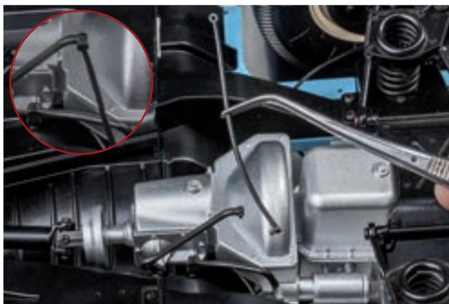
Соберите узел переключения передач. Для этого закрепите тягу второй и третьей передач (на фото более длинная тяга) на крепежной оси рычага переключения второй и третьей передач. При фиксации детали убедитесь в том, что свободный конец тяги своим крепежным штифтом направлен в сторону задней части модели.
