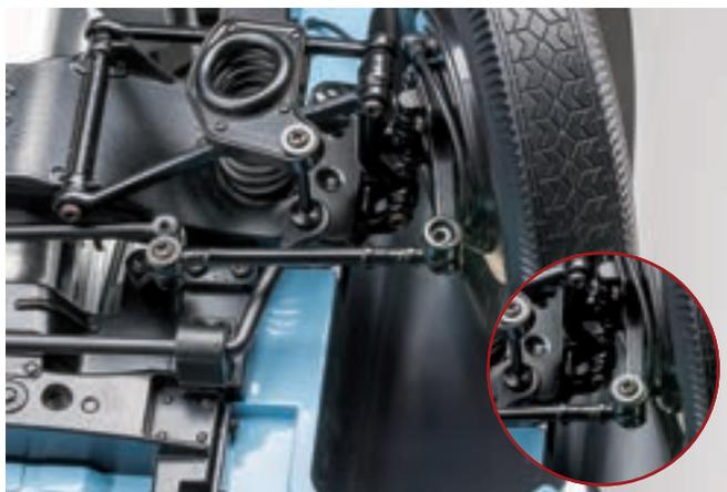
Свободный конец рулевой тяги вставьте в отверстие правого рычага рулевой трапеции и зафиксируйте винтом 2,0×3 с пресс-шайбой (GM).
